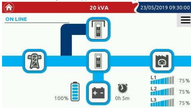
*Домашняя страница, на которой отображается работа ИБП в режиме ECO
